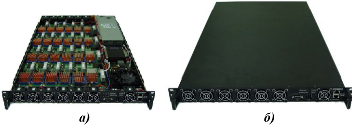
Рис. 2. Фотографии вычислительного модуля (ВМ) 24V7-750: а) со снятой верхней крышкой, б) с установленной верхней крышкой
