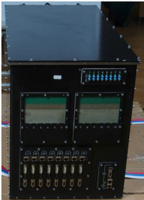
Вычислительный комплекс с иммерсионной системой охлаждения на основе высокопроизводительной вычислительной платформы EC1740.0001
