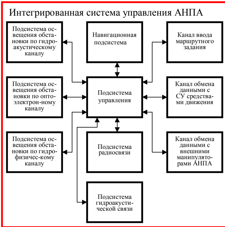
Рис.1. Структурная схема ИСУ АНПА
