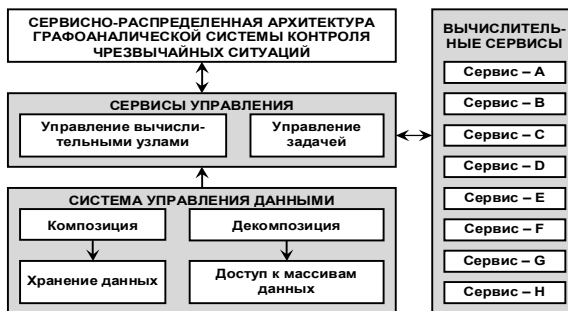
Рис. 2. Сервисно-распределенная архитектура организации параллельных вычислений при интерпретации TS-систем
