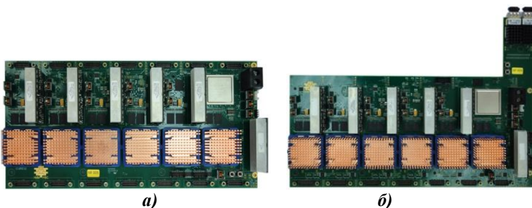
Рис. 1. Фотографии платы ПВМ 6V7-180: а) ПВМ №0-2 ВМ 24V7-750, б) ПВМ №3 ВМ 24V7-750 с оптическим разъемом для связи с другими ВМ 24V7-750
